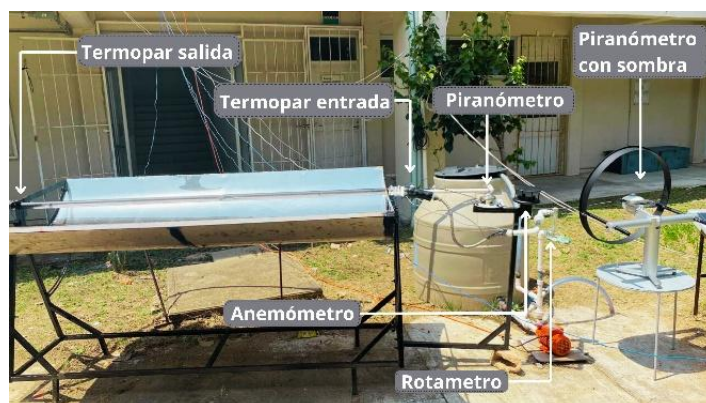
Figura 1. Colector cilindro-parabólico experimental.
