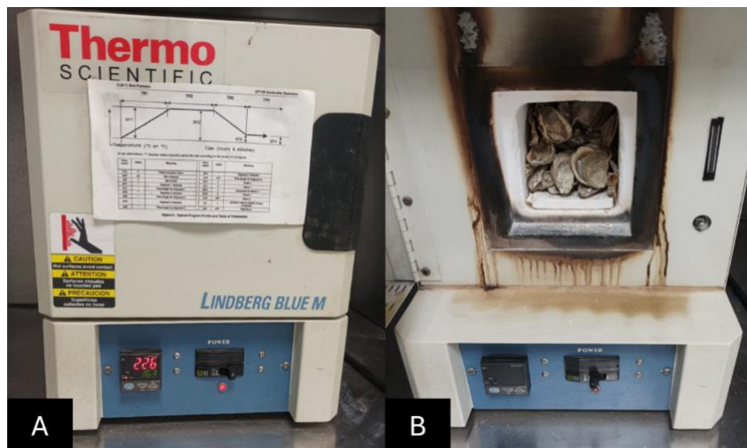
Figura 4. Horno de calcinación. (a) Horno Thermo Scientific Lindberg Blue M; (b) conchas de ostión antes de su calcinación.
