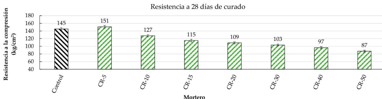
Figura 5. Resistencia a la compresión a 28 días de curado.
