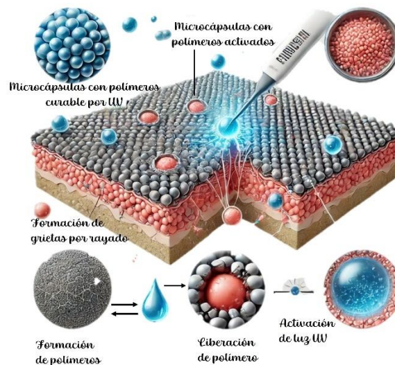
Figura 2. Recubrimientos autorreparables basados en microcapsulas curables po UV.
