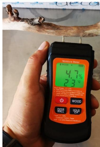
Figura 2 Medición de la humedad de la madera
