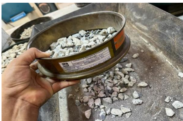
Figura 5. Tamizado de grava artificial.
