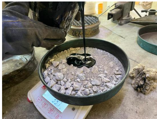
Figura 8. Inicio de mezcla asfáltica.
