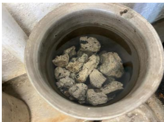
Figura 2. Inmersión del RCD en agua.
